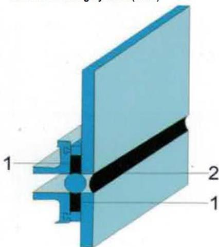
1- SANZ SG-9100 Двухкомпонентный структурный силиконовый клей-герметик SGS или
